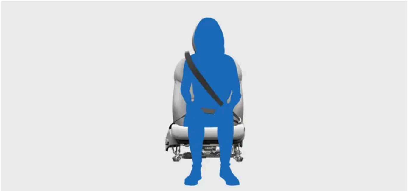
Ceinture de sécurité correctement bouclée et ajustée
