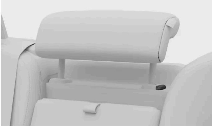
Bouton de verrouillage sur l'appui-tête
