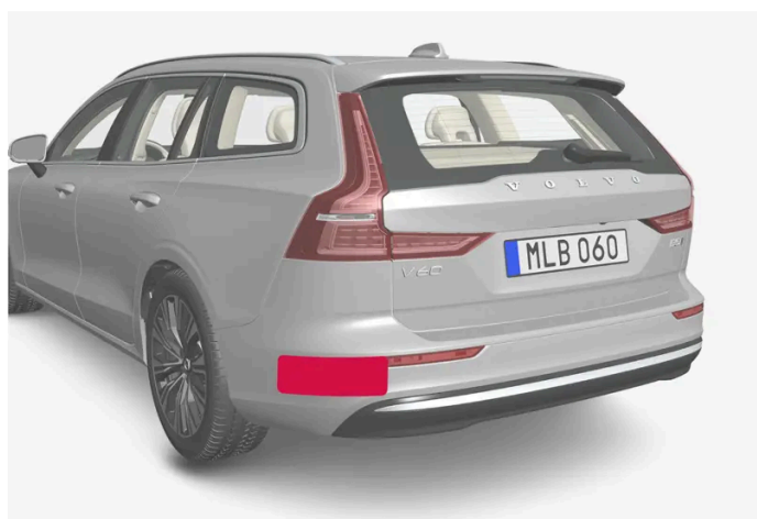
Position des unités radar arrière
