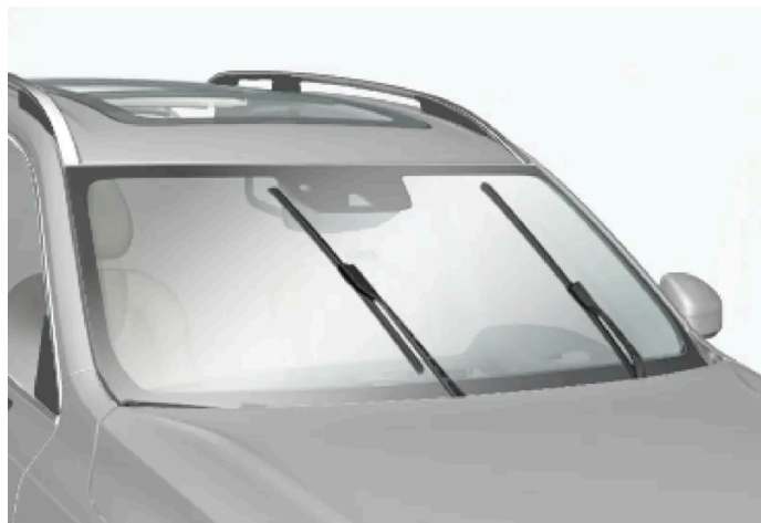
Balais d'essuie-glace en position d'entretien.
