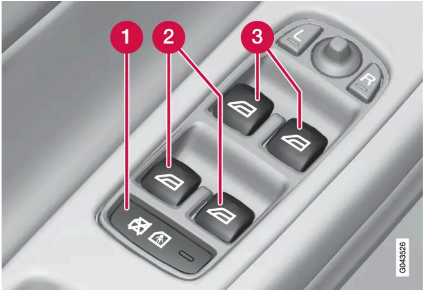
Panneau de commande de la porte conducteur.
