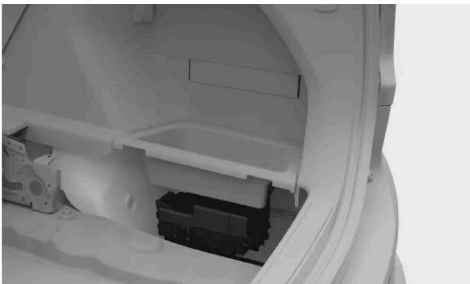
Emplacement de la boîte à fusibles
