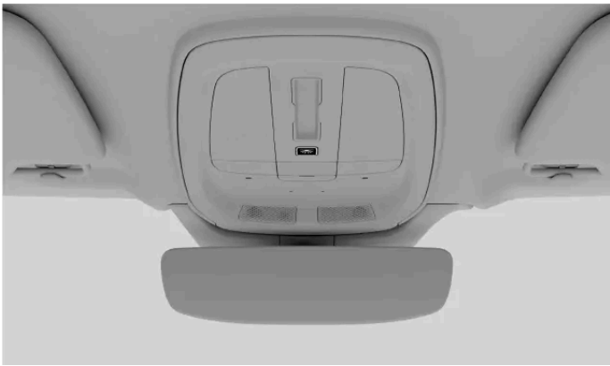
Bouton d'extinction automatique des lampes sur la console au plafond
