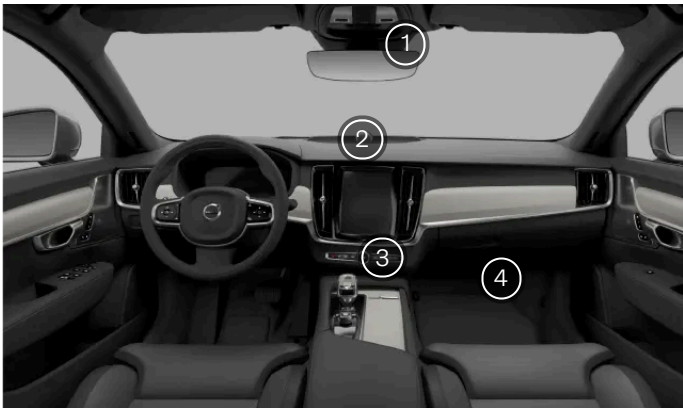
Capteurs intérieurs de climatisation
