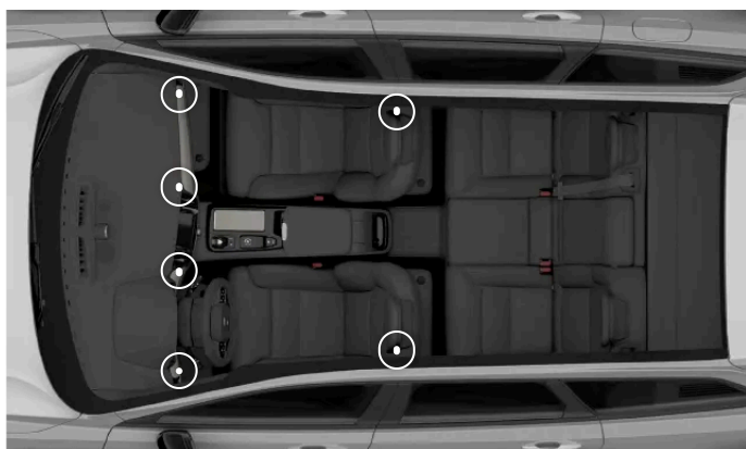
Position des buses de ventilation réglables
