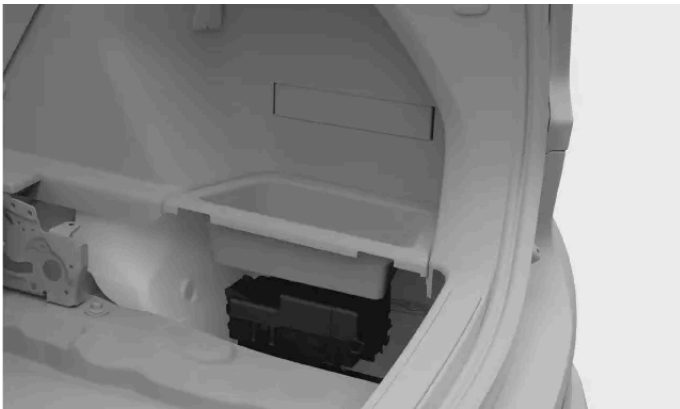
Emplacement de la boîte à fusibles
