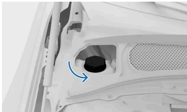
Dévissez le couvercle du réservoir de liquide de refroidissement.
