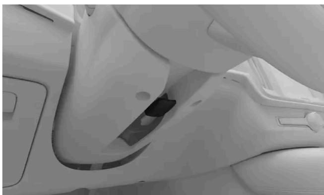
**2** Agrippez le volant et ajustez sa position.
