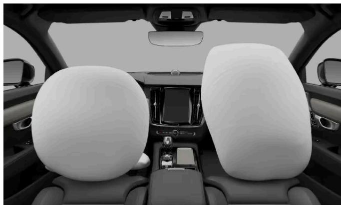
Les côtés conducteur et passager possèdent chacun un coussin gonflable avant. Le coussin gonflable du côté conducteur est intégré au volant et le coussin gonflable du côté passager est intégré dans un panneau au-dessus de la boîte à gants.
