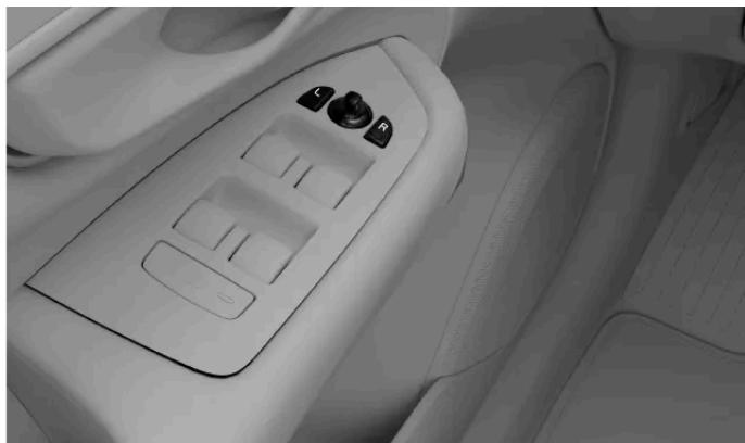
Commandes de réglage des rétroviseurs extérieurs
