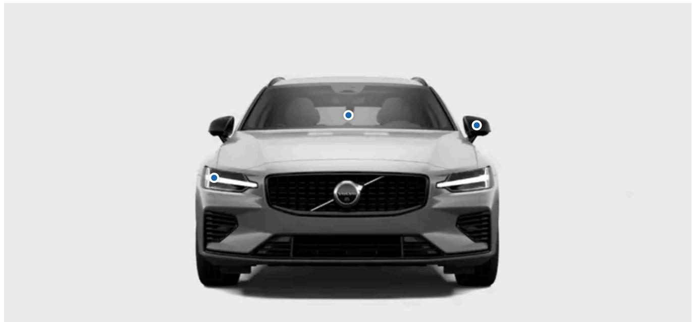
Vue de la face avant de la voiture présentant les feux extérieurs, les rétroviseurs et les essuie-glaces de pare-brise
