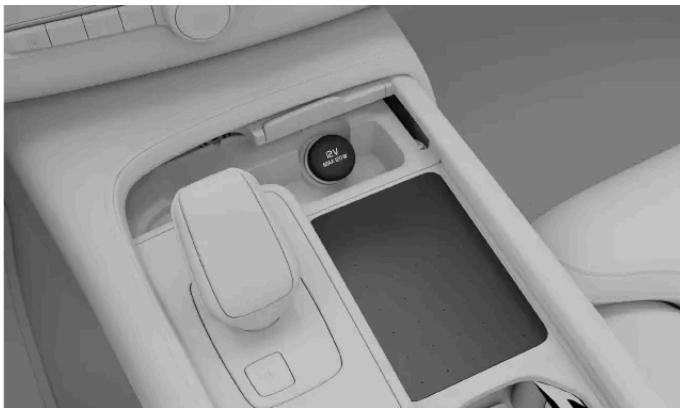
La prise 12 V dans la console de tunnel
