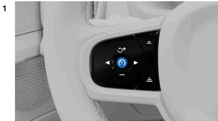
Lorsque Pilot Assist peut être activé en toute sécurité, appuyez sur le bouton
