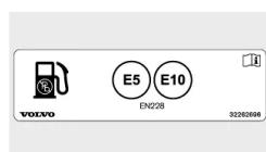
L'essence avec l'identifiant suivant peut être utilisée dans le voitures avec moteur à essence :
