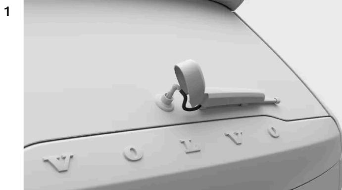
Trouvez le couvercle en plastique à l'endroit où le bras d'essuie-glace est fixé à la voiture. Détachez en premier le côté du couvercle le plus proche puis le côté le plus éloigné de vous. Soulevez entièrement le couvercle en plastique. Cela vous donnera accès au raccord de flexible.
