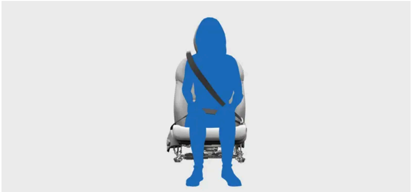
Ceinture de sécurité correctement bouclée et ajustée
