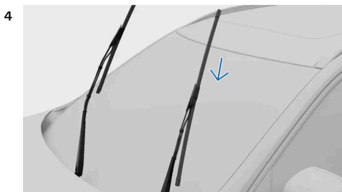
Vérifiez que le balais côté conducteur est plus long que celui du côté passager. Faites glisser le balai d'essuie-glace sur le bras d'essuie-glace. Vérifiez que la goupille du bras d'essuie-glace entre dans l'orifice du balais d'essuie-glace. Poussez le balai dans le bras d'essuie-glace jusqu'à ce qu'un déclic se fasse entendre.
