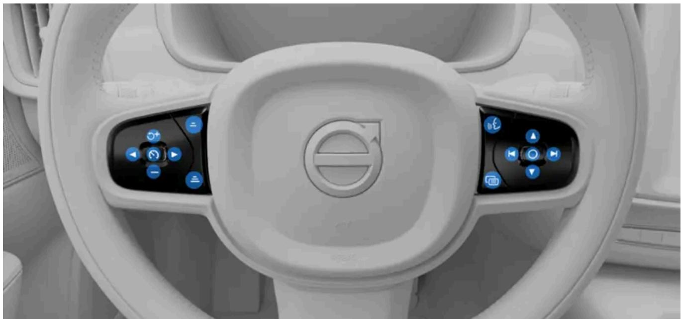
Les commandes situées sur le côté gauche de votre volant permettent de contrôler les fonctions d'assistance au conducteur.
