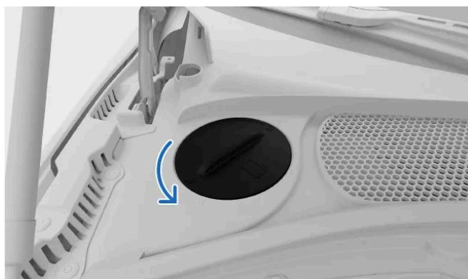
Ouvrez la trappe de panneau dans le coin supérieur gauche du compartiment moteur pour accéder au réservoir de liquide de refroidissement.
