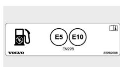
L'essence avec l'identifiant suivant peut être utilisée dans le voitures avec moteur à essence :
