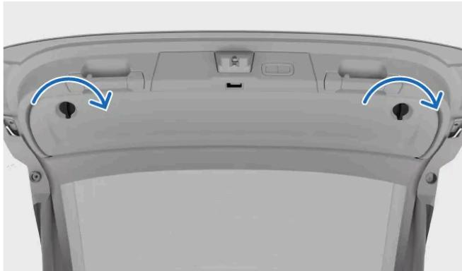
Le triangle de présignalisation est rangé à l'intérieur du hayon/couvercle de coffre. Ouvrez le compartiment en tournant les manettes à la verticale, puis en les tirant.
