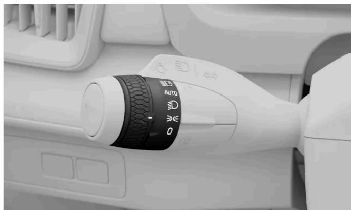
Symbol des feux de position sur la bague tournante du levier de commande gauche
