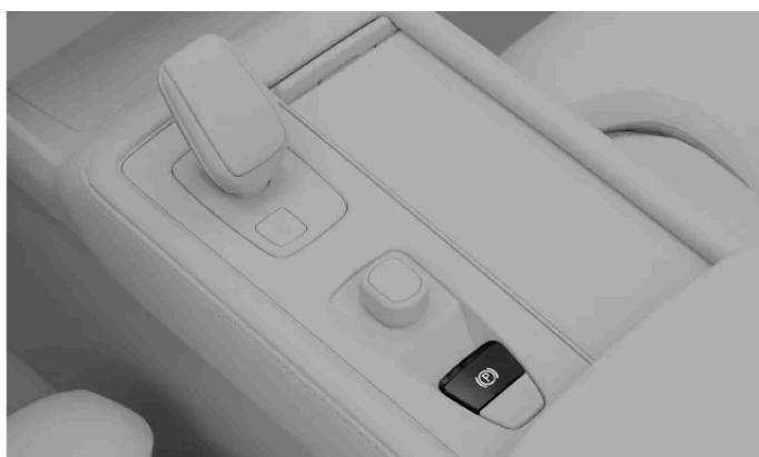
Engagez manuellement le frein de stationnement en tirant sur l'interrupteur de frein de stationnement.
