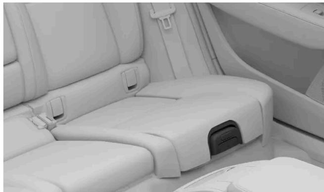
Tirez sur la poignée à l'avant du coussin de siège pour déverrouiller le mécanisme.
