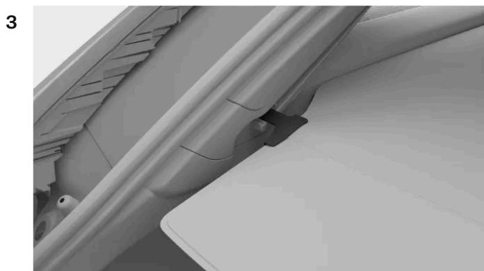
Guidez les extrémités du cache-bagages en position verrouillée dans les rainures.
