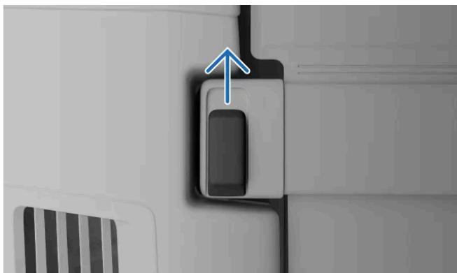
Les extrémités du cache-bagages comportent des boutons de verrouillage. Poussez vers l'avant le bouton de l'un des côtés et tenez-le tout en soulevant l'extrémité du cache-bagages. Procédez de la même façon pour l'autre extrémité du cache-bagages.
