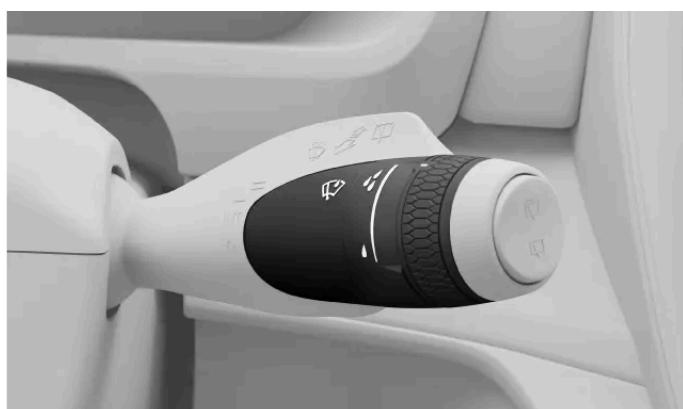
Les commandes des essuie-glaces avant se trouvent sur le levier de commande au volant droit.
