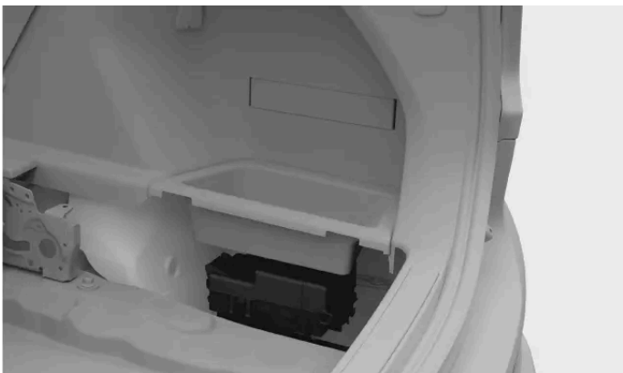
Emplacement de la boîte à fusibles
