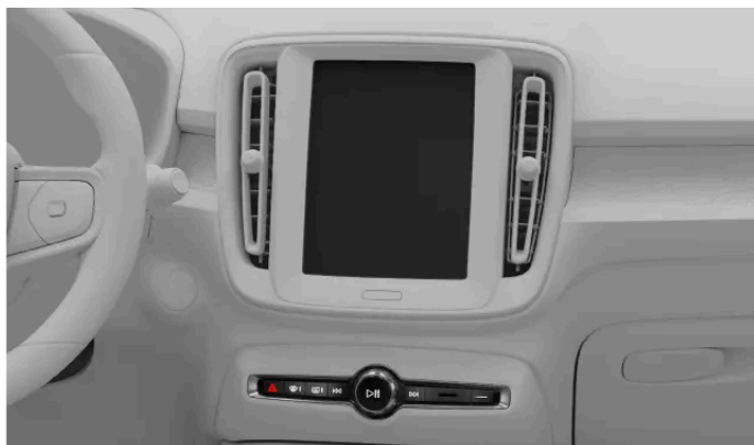
Boutons de l'écran central et du dégivreur sur le panneau de boutons en dessous de l'écran central
