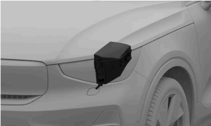
Emplacement de la boîte à fusibles
