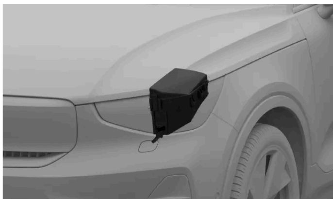
Emplacement de la boîte à fusibles
