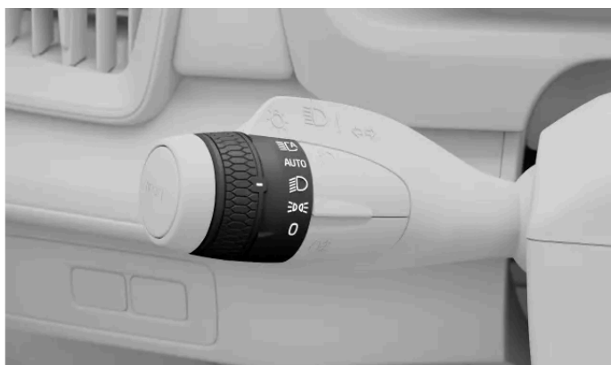
Symbole des feux de croisement sur la molette du levier de commande gauche
