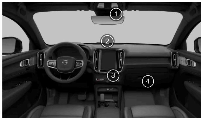
Capteurs intérieurs de climatisation
