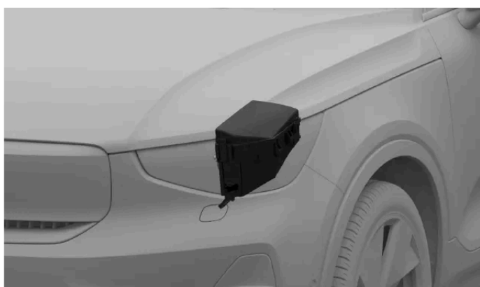
Emplacement de la boîte à fusibles
