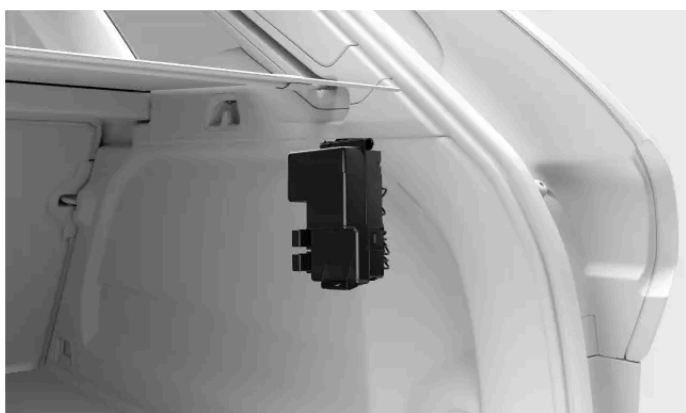
Emplacement de la boîte à fusibles
