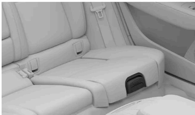
Tirez sur la poignée à l'avant du coussin de siège pour déverrouiller le mécanisme.
