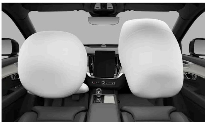
Le côté conducteur est équipé de deux coussins gonflables avant. Le coussin gonflable supérieur est placé à l'intérieur du volant, et le coussin gonflable de genou est placé derrière un panneau en dessous du volant.
