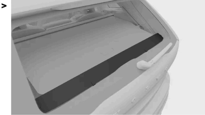
Le couvercle de hayon/couvercle de coffre est installé et recouvre le compartiment de rangement du coffre.
