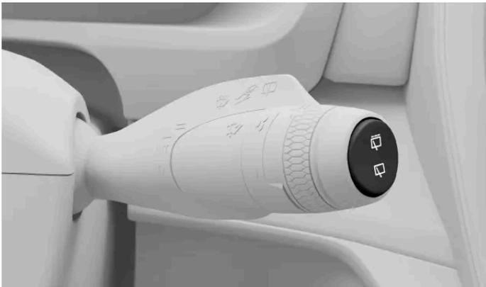
Les commandes de l'essuie-glace arrière se trouvent sur le levier de commande au volant droit
