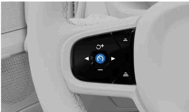
Lorsque Pilot Assist peut être activé en toute sécurité, appuyez sur le bouton
