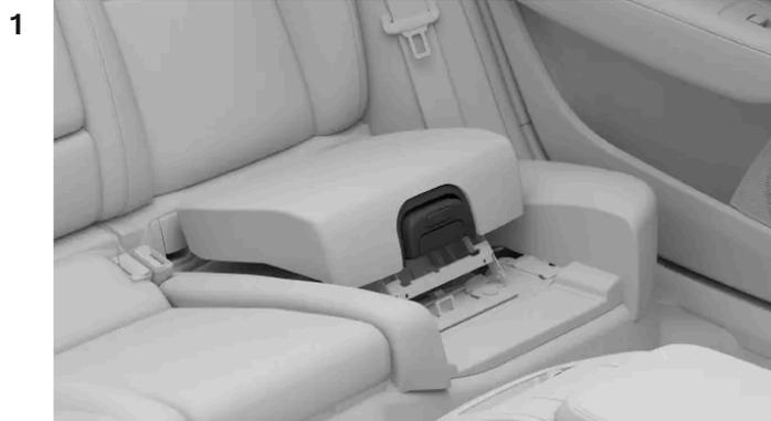
Tirez sur la poignée à l'avant du coussin du siège pour enfant pour déverrouiller le mécanisme.
