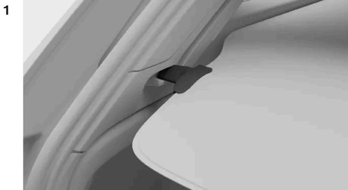
Soulevez et tirez l'extrémité de la protection du cache-bagages par la poignée pour la déverrouiller. Cela permet au couvercle de cache-bagages de se rétracter.
