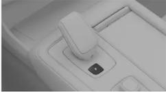
Lorsque P est sélectionné, la boîte de vitesses est bloquée mécaniquement pour éviter les changements de rapports accidentels.
