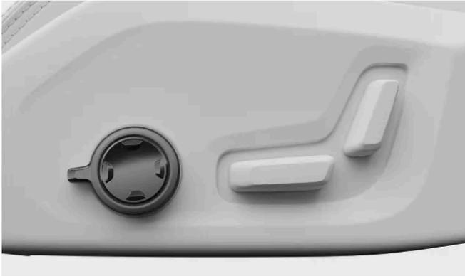
La commande de réglage du siège est située sur le côté extérieur du siège.
