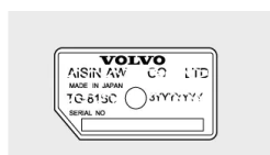
Plaque signalétique de la boîte de vitesses
