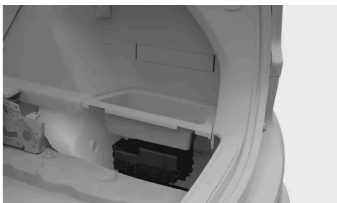
Emplacement de la boîte à fusibles
