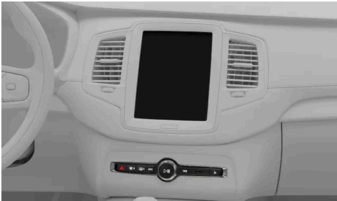
Boutons de l'écran central et du dégivreur sur le panneau de boutons en dessous de l'écran central
