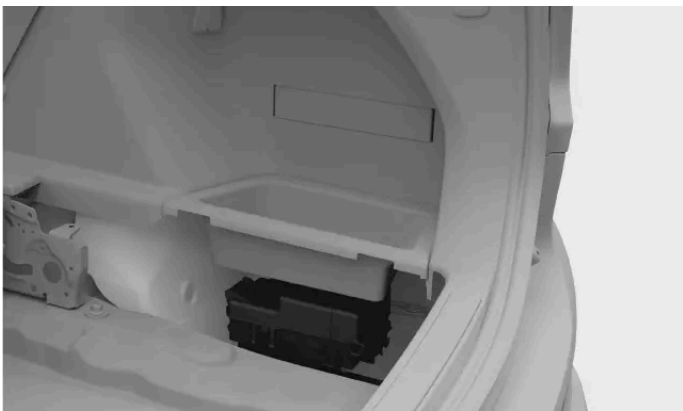
Emplacement de la boîte à fusibles
