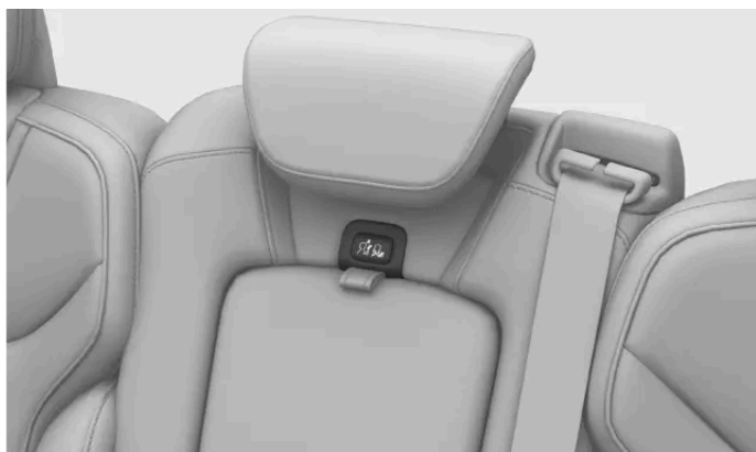
Bouton de verrouillage sur l'appui-tête central
