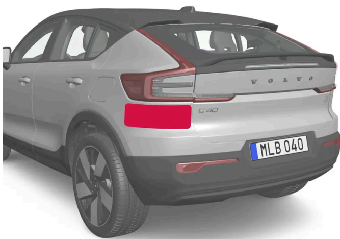
Locatie van de radarsensoren aan de achterzijde
