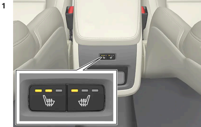
Knoppen voor elektrische achterbankverwarming achter op tunnelconsole.
