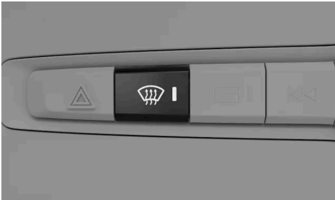
Knop voor maximale ontdooifunctie op het bedieningspaneel onder het middendisplay
