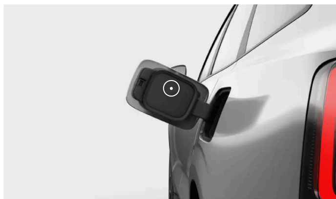
Het identificatielabel bevindt zich aan de binnenzijde van de laadklep.
