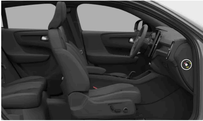
Locatie van de schakelaar voor de passagiersairbag
