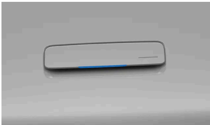
Aanraakpunt op de onderkant van de portierhandgreep.
