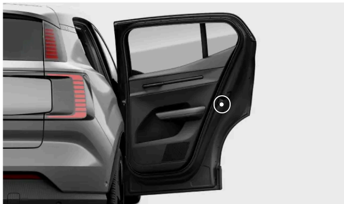
Positie van de schakelaar van het kinderslot.
