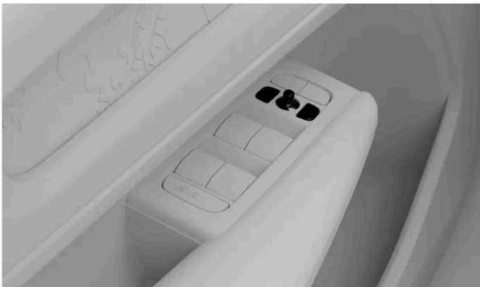
Knoppen voor het verstellen van de buitenspiegels
