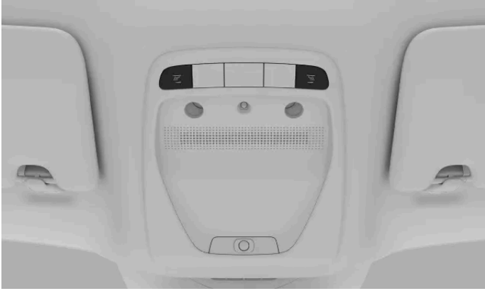
De leeslampjes voor de voorstoelen in de plafondconsole
