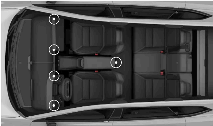
De posities van de verstelbare blaasmonden in het interieur.
