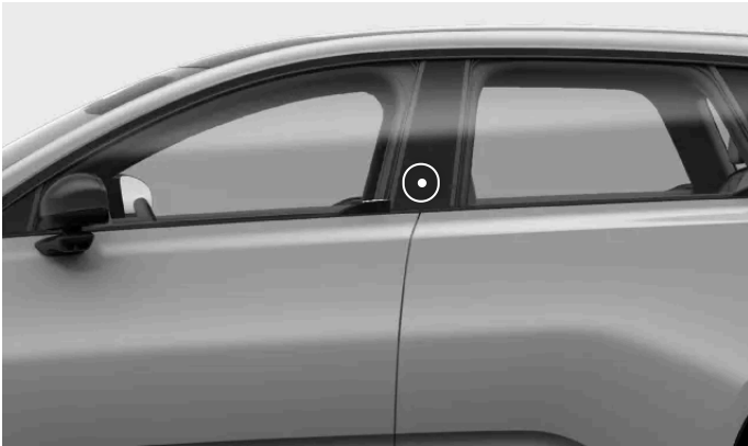
Locatie voor het lezen van sleutels op de stijl van het bestuurdersportier
