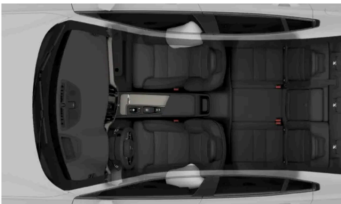
Zijairbags voor de inzittenden voorin.
