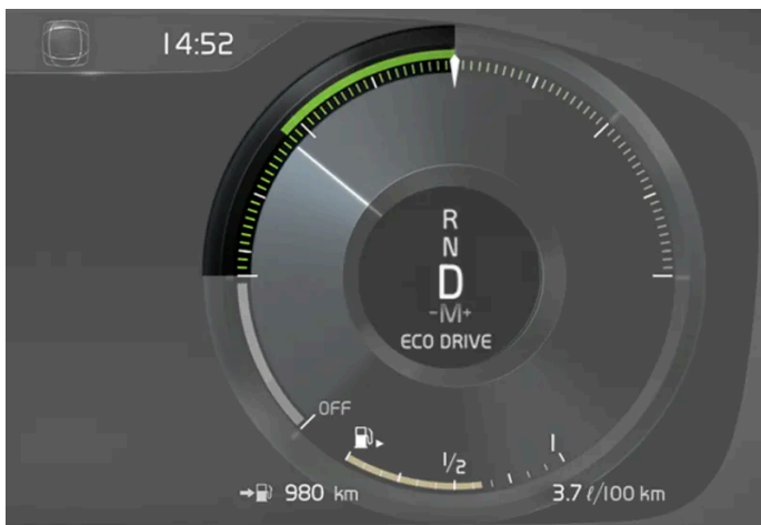
ECO-meter op 12 inch bestuurdersdisplay*.
