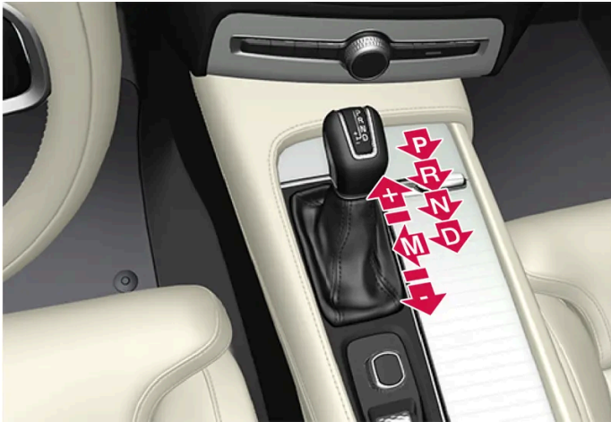
Overzicht grote schakelhendel en schakelstanden.
