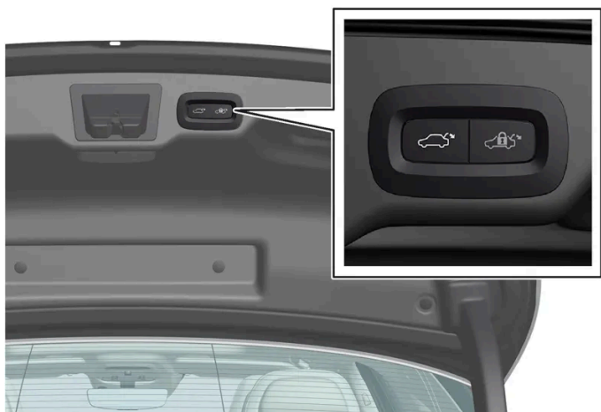
Positie van de knop aan de onderkant van het kofferdeksel.
