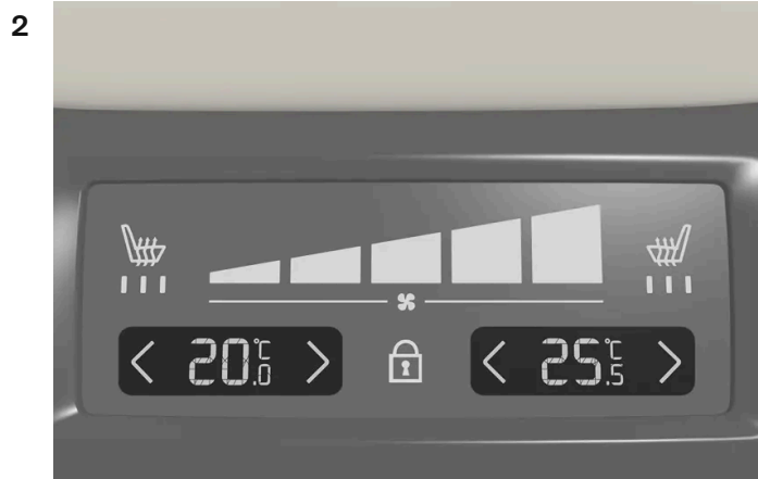
Temperatuurregeling op klimaatpaneel achter op tunnelconsole.
