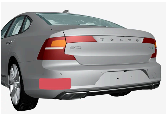
Locatie van de radarsensoren aan de achterzijde
