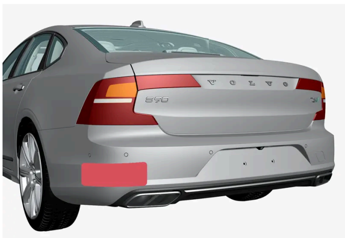
Locatie van de radarsensoren aan de achterzijde
