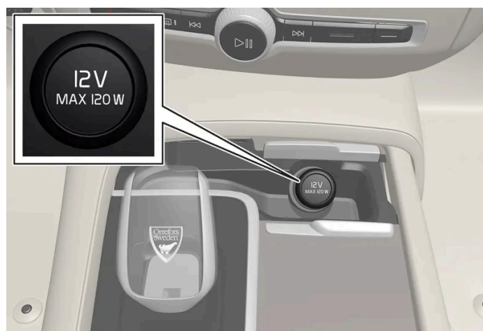
De voorste aansluiting van de tunnelconsole voor auto met draadloze telefoonoplader*.
