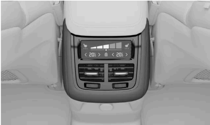
Bedieningselementen voor het klimaatsysteem op de tunnelconsole
