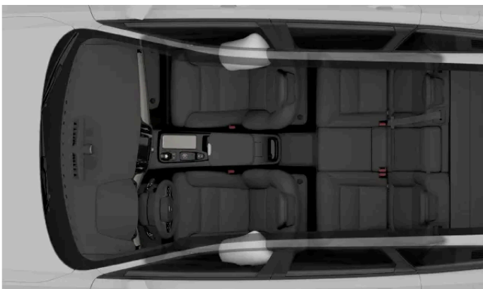
Zijairbags voor de inzittenden voorin.
