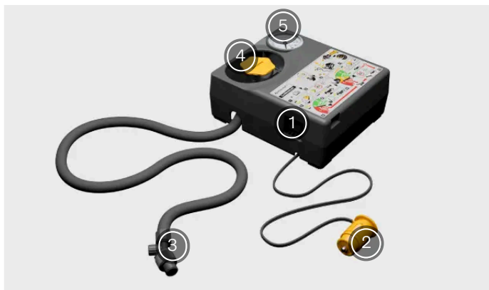
Overzicht van de compressor van de noodreparatieset
