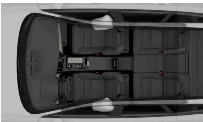
Zijairbags voor de inzittenden voorin.
