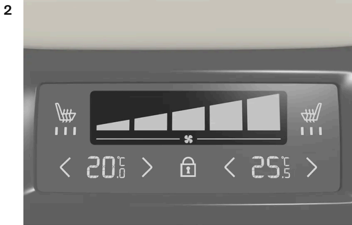
Ventilatorregeling op klimaatpaneel achter op tunnelconsole.
