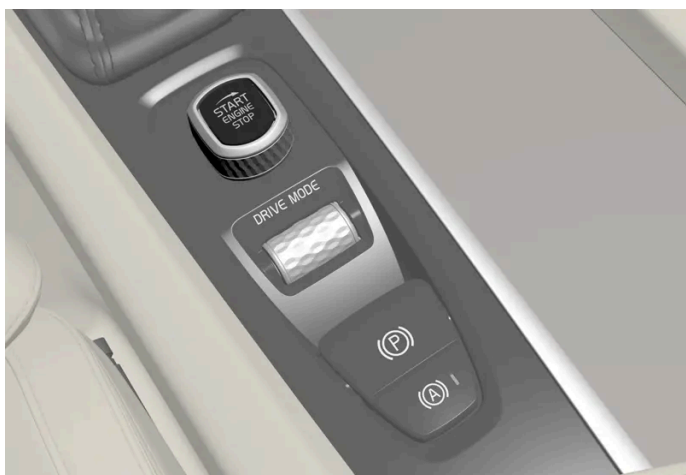
De startknop op de tunnelconsole.
