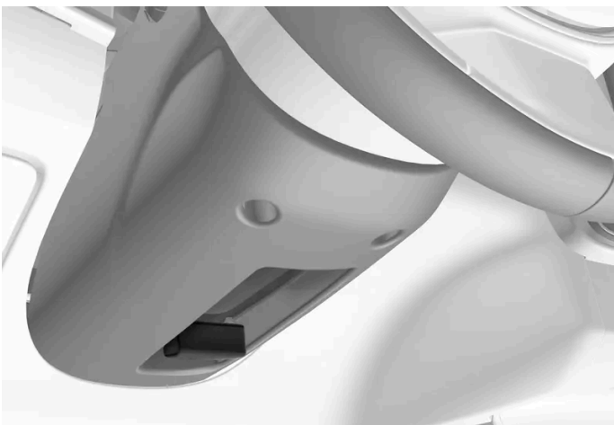
Hendel voor verstelling van het stuurwiel.
