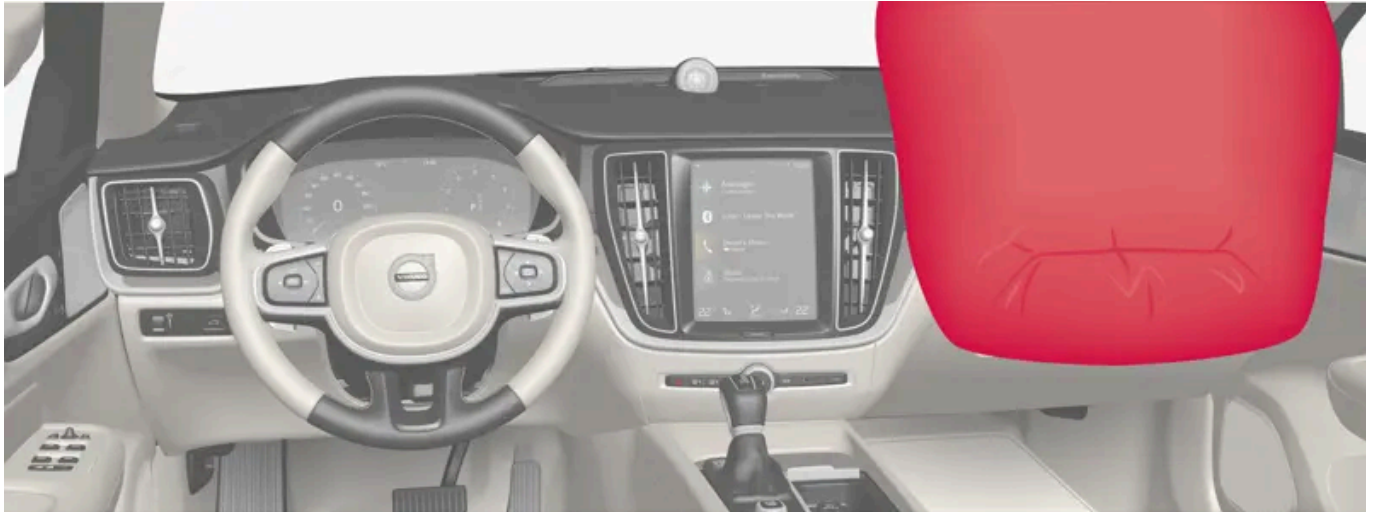
Airbag voor de voorstoel aan passagierszijde.
