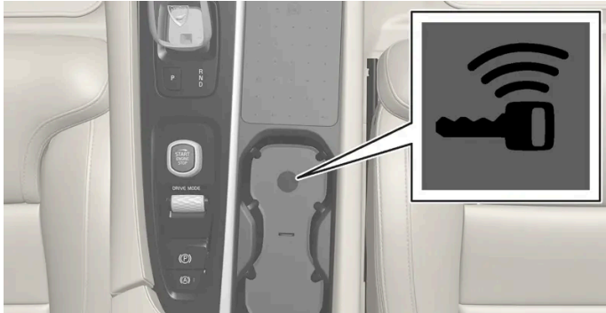
Positie back-uplezer in de tunnelconsole.
