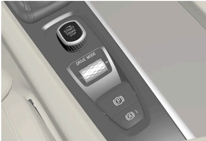
De startknop op de tunnelconsole.
