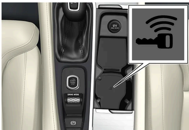
Positie back-uplezer in de tunnelconsole.
