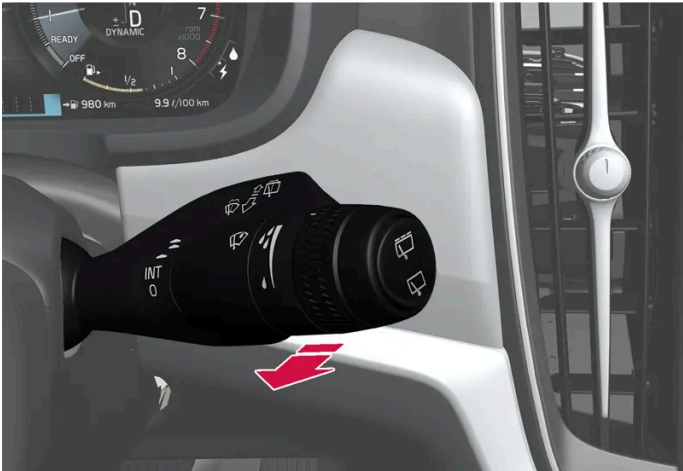
Sproeifunctie, rechter stuurhendel.
