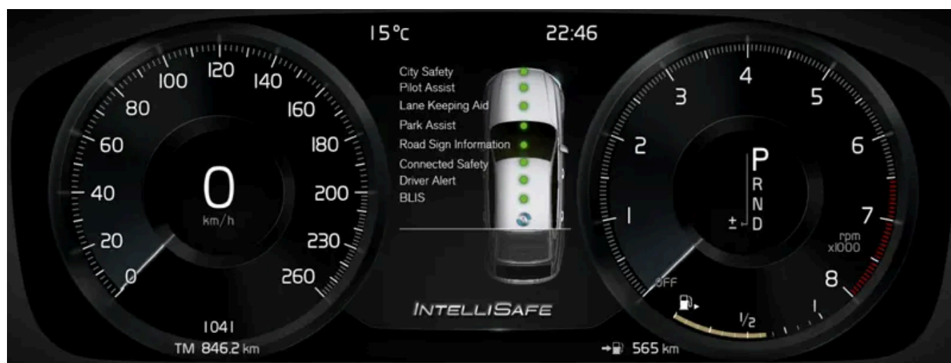
De afbeelding toont het 12" bestuurdersdisplay
