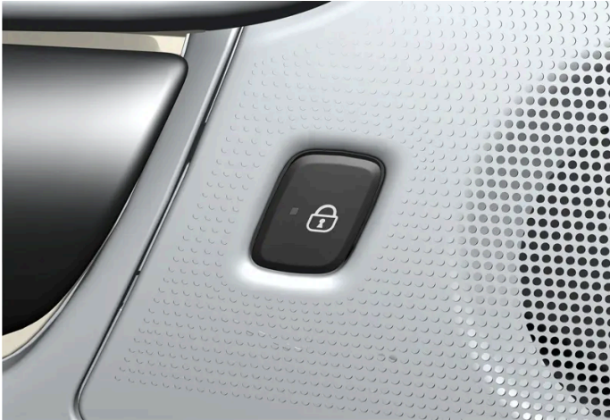
Knop voor vergrendelen in achterportier met led.
