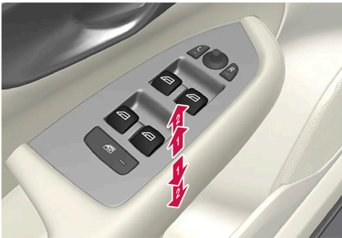
Bedieningsknoppen elektrisch bedienbare ruiten.
