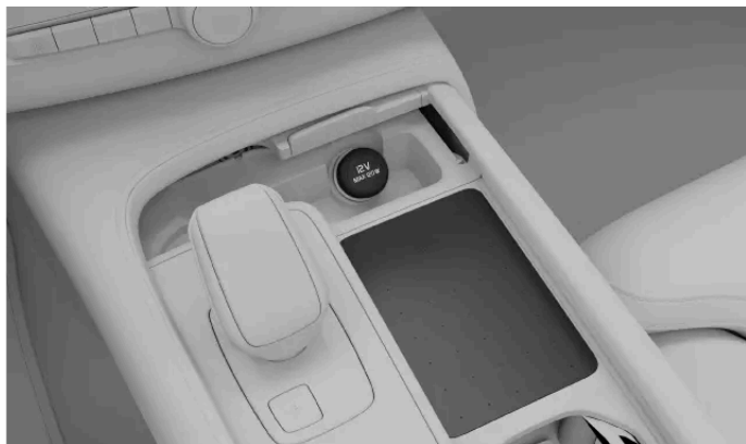
De 12V-aansluiting in de tunnelconsole
