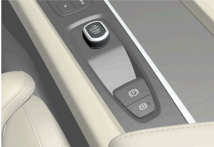
De startknop op de tunnelconsole.
