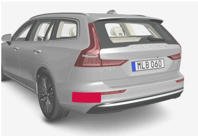
Locatie van de radarsensoren aan de achterzijde
