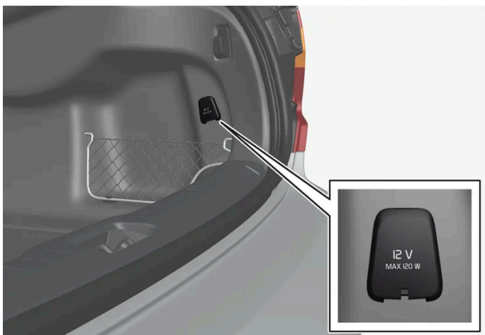
12V-aansluiting in kofferbak/bagageruimte*.
