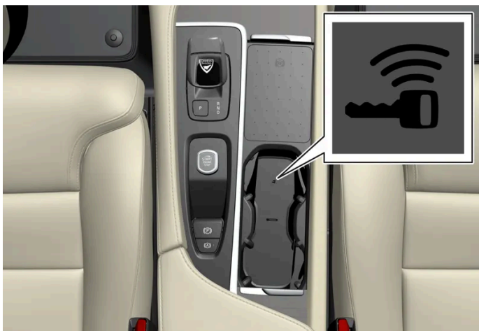
Positie back-uplezer in de tunnelconsole.
