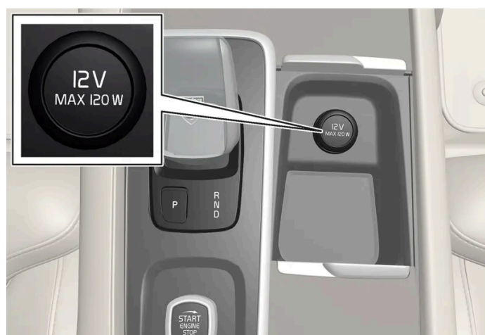
De voorste aansluiting van de tunnelconsole voor auto zonder draadloze telefoonoplader*.
