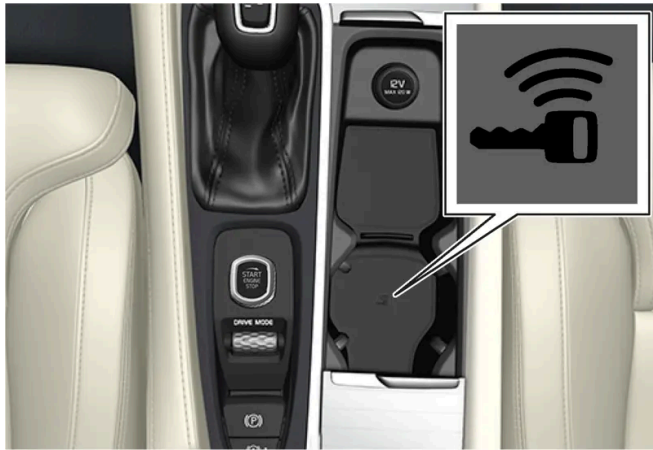
Positie back-uplezer in de tunnelconsole.
