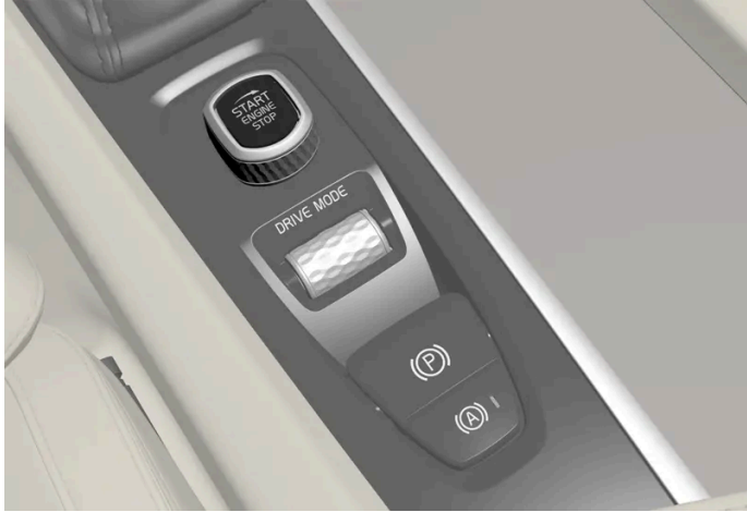
De startknop op de tunnelconsole.
