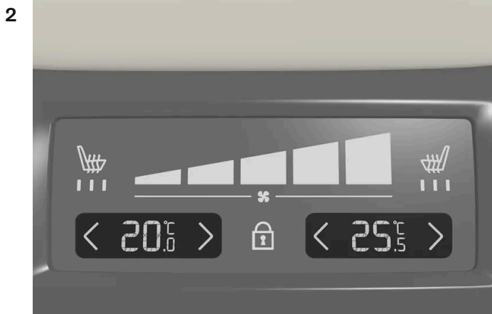
Temperatuurregeling op klimaatpaneel achter op tunnelconsole.
