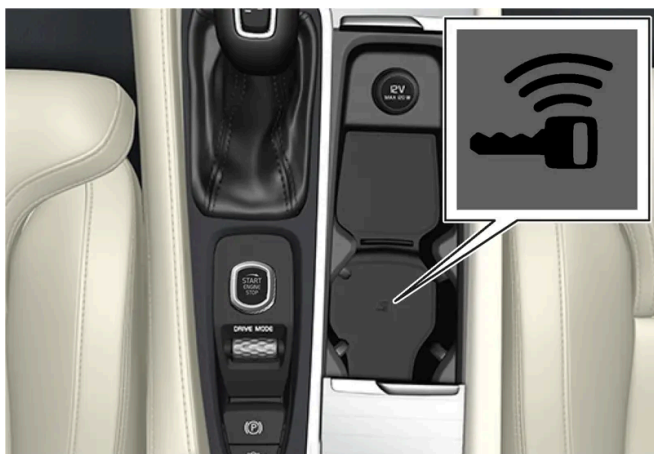
Positie back-uplezer in de tunnelconsole.
