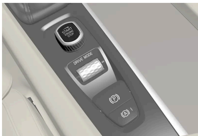
De startknop op de tunnelconsole.
