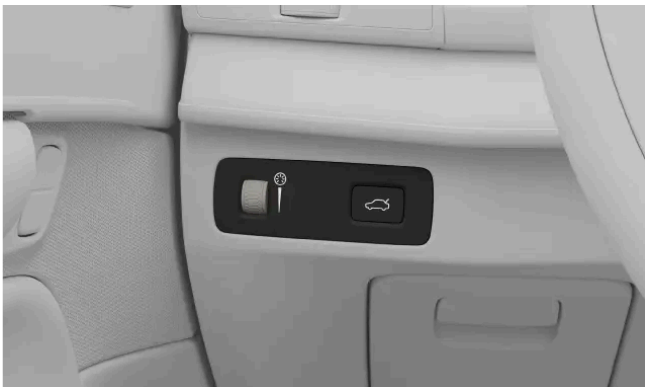
Het duimwiel voor de afstelling van de interieurverlichting
