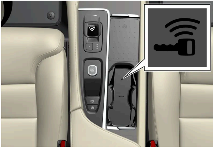
Positie back-uplezer in de tunnelconsole.
