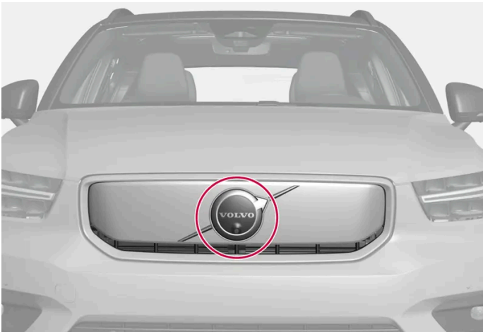
Positie van de voorste radarsensor
