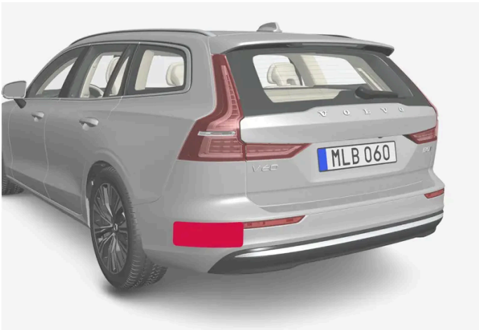
Locatie van de radarsensoren aan de achterzijde
