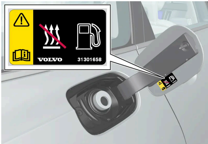
Sticker aan binnenkant tankvulklep.
