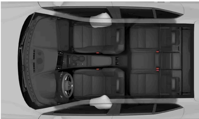
Zijairbags voor de inzittenden voorin.
