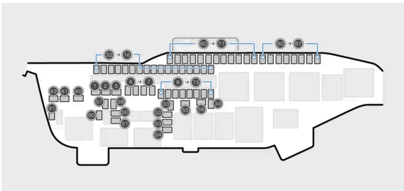
Schema met de posities van de zekeringen
