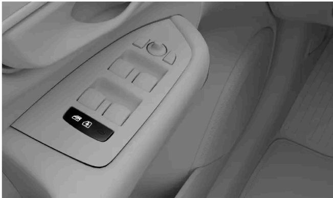
Locatie van de knop voor het kinderslot op het portierpaneel
