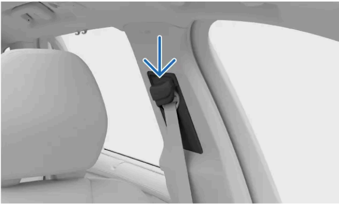
Bovenste bevestigingspunt van de stoel
