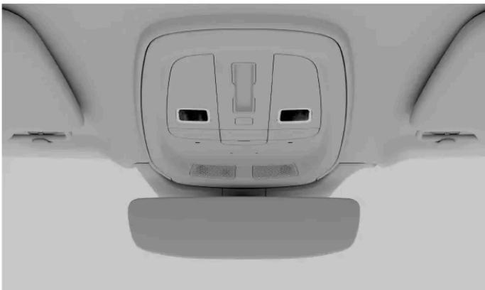
De leeslampjes voorin in de plafondconsole
