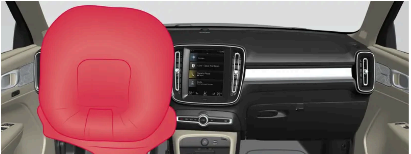
De stuurairbag en knie-airbag [1] voorin aan de bestuurderszijde.
