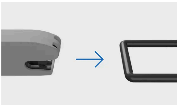
Bevestiging aan een ISOFIX-verankeringspunt
