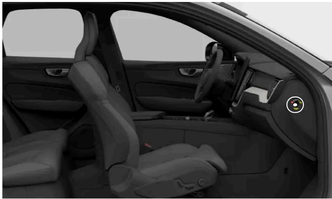
Locatie van de schakelaar voor de passagiersairbag
