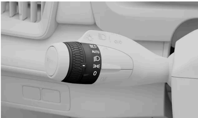
Het symbool voor parkeerlichten op de draairing op de linkerstuurhendel
